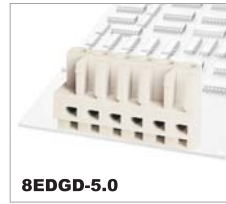
8EDGD-5.0 CE 320V/20A — UL 300V/15A — Poles 2P-24P
