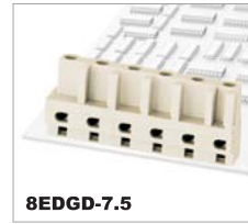
8EDGD-7.5 CE 400V/20A — UL 300V/15A — Poles 2P-12P
