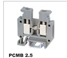
PCMB 2.5 CE 400V/24A 0.2-2.5mm 2 UL 300V/20A 28-12AWG T/W/End plate 5.2/28/1.5mm
