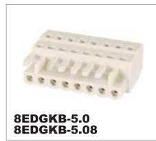
8EDGKB-5.0 8EDGKB-5.08 CE 320V/20A 0.2-2.5mm 2 UL 300V/15A 22-14AWG Poles 2P-24P
