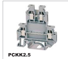
PCKK2.5 CE 500V/24A 0.2-2.5mm 2 UL 300V/20A 24-12AWG T/W/End plate 5.2/56/2.6mm
