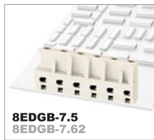
8EDGB-7.5 8EDGB-7.62 CE 400V/20A — UL 300V/15A — Poles 2P-12P
