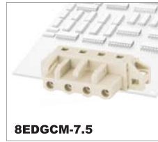
8EDGCM-7.5 CE 400V/20A — UL 300V/15A — Poles 2P-12P
