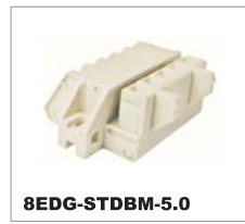
8EDG-STDBM-5.0 CE 320V/20A 2.5mm 2 UL 300V/15A 22-14AWG Poles 2P-24P
